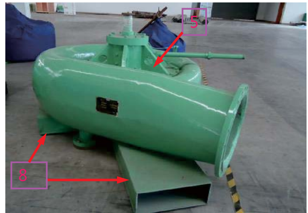
1進水的金屬蝸殼 2座環 3負曲率導葉 4轉輪葉片 5上蓋&軸承座 6主軸 7支墩 8側出水箱
